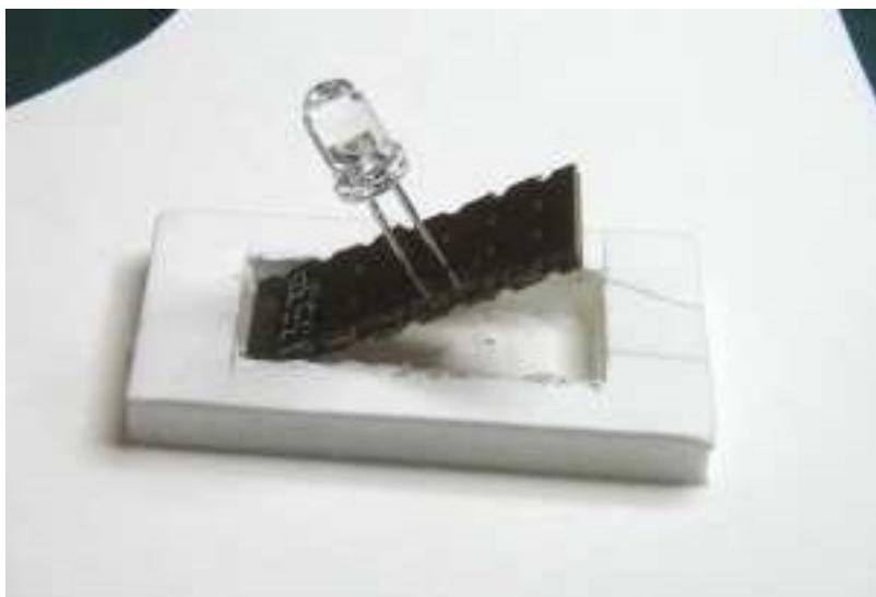
Des trous sont pratiqués en périphérie de la couche supérieure de la base de manière à laisser passer les fils qui connecteront les LEDs. La photo suivante montre le positionnement des LEDs et le câblage électrique réalisé pour chaque LED :
