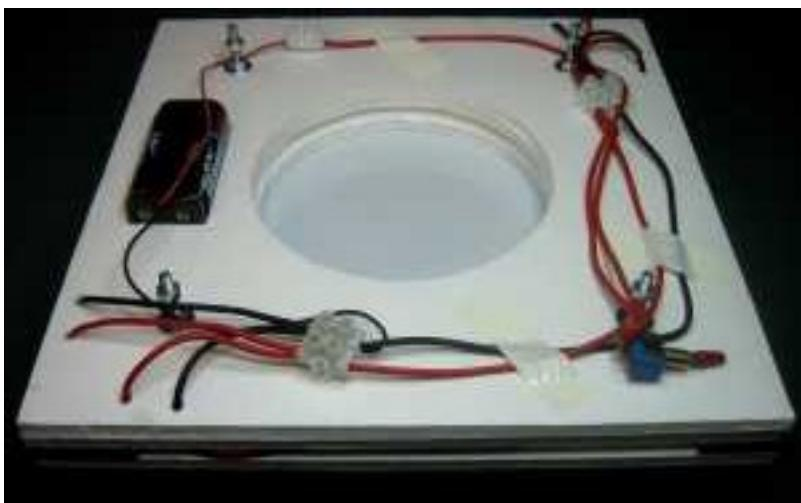
L'interrupteur est laissé volant en périphérie de la base de manière à pouvoir être facilement accessible. Les fils sont fixés sur la base à l'aide de ruban adhésif de manière à ce qu'ils ne viennent pas au-dessus du trou de l'objectif.
