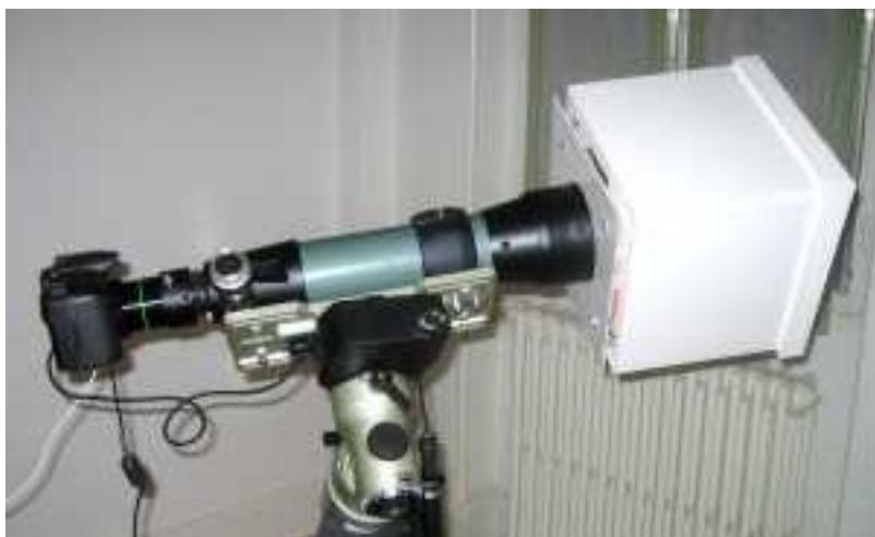
Dans le cas de ce montage, quelques essais montrent que l'on obtient une dynamique convenable avec une pose de 0,25 secondes. Les PLUs obtenus tirent un peu sur le vert dans les images couleur obtenues sur le Canon EOS 20D. Ceci est tout à fait similaire à ce qui est obtenu en réalisant des PLUs sur un fond de ciel à l'aube.
